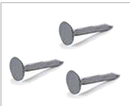
Καρφιά Καρφιά πλατυκέφαλα γαλβανισμένα μήκους 2 cm (1 Kg/25 m 2 στέγης περίπου).
